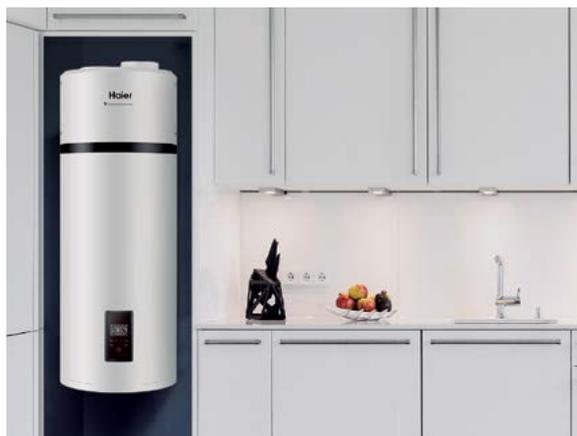
a los requisitos de los usuarios. Las bombas de calor ACS extraen el calor del aire y utilizan esta energía para calentar el agua caliente sanitaria que utilizamos. La energía extraída del aire se transfiere mediante refrigerante a un intercambiador de calor para producir agua caliente. El M5 HPWH funciona con refrigerante R134a, lo que permite ofrecer una temperatura del agua mucho más alta.
