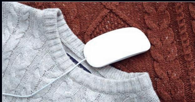
**ImaWash** es el proyecto de una start up de Singapur consistente en una lavadora portátil para llevar de viaje. El dispositivo, de la apariencia y el tamaño similar a un ratón de ordenador, se introduce con la ropa sucia en un recipiente con agua (cubo, lavabo, bañera...) y detergente. Una vez enchufado, basta una media hora para que el aparato limpie la ropa utilizando tecnología por ultrasonidos. Su precio podría rondar los 110 dólares. [imawash.com](http://imawash.com)
